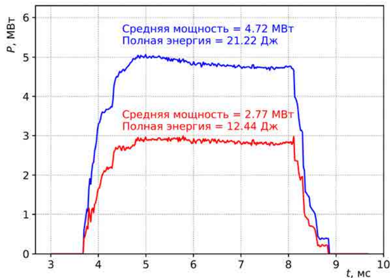
Рисунок 2.2. Сигналы мощности атомарной инжекции с указанием их среднего значения, а также полной энергии пучков в «фоновом» выстреле (синяя кривая) и в выстреле с плазмой (красная кривая).
