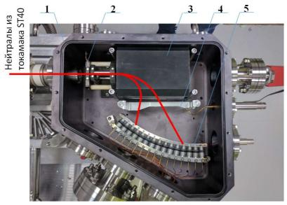
**Рисунок 1.** Конструкция анализатора; 1 — корпус, 2 — узел обдирочной фольги, 3 — магнит-анализатор, 4 — электростатические дефлекторные пластины, 5 — детекторный узел.
