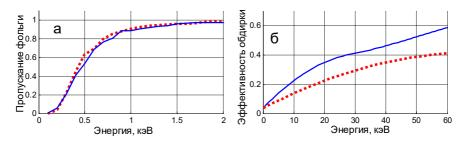
**Рис. 10.** а — вероятность прохождения иона через углеродную фольгу толщиной 18 нм (расчеты SRIM), б — доля положительных ионов ( $H^+$ ,  $D^+$ ) на выходе из фольги (интерполяция литературных данных [11],[12]). Синяя непрерывная линия — водород, красный пунктир — дейтерий.
