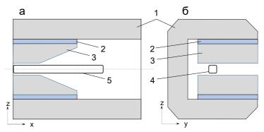
Рис. 2. Магнит-анализатор. а – вид сбоку (со стороны детекторов), б – вид спереди (со стороны токамака); 1 – ярмо магнита, 2 – постоянные магниты, 3 – полюса магнита, 4 – отверстие входной апертуры, 5 – отверстие выходной апертуры (корпуса входной и выходной апертур не показаны).
