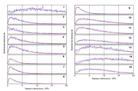
**Рис. 6**. Амплитудные распределения каналов регистрации анализатора (выстрел ST40 #6141). Красные кривые – аппроксимация логнормальной функцией.
