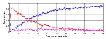
Рис. 11. Прохождение частиц в анализаторе, синий — доля частиц, достигших детекторной поверхности, красный — доля частиц, попавших во входную диафрагму, пурпурный — доля частиц, попадавших на выходную диафрагму магнита, черный — доля частиц, попавших на дефлекторные пластины.
