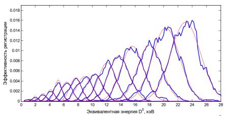
**Рис. 13.** Аппаратные функции анализатора для атомов дейтерия  $D^0$ . Напряжение на обдирочной фольге +4 кВ, напряжение на дефлекторных пластинах -4 кВ. Синие линии – расчет, красные – аппроксимация гауссовской функцией.
