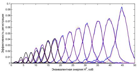
**Рис. 12** Аппаратные функции анализатора для атомов водорода H<sup>0</sup>. Напряжение на обдирочной фольге +8 кВ, напряжение на дефлекторных пластинах -8 кВ. Синие линии — расчет, красные — аппроксимация гауссовской функцией, черные — измерения (данные калибровки, описанной в разделе 2.1).
