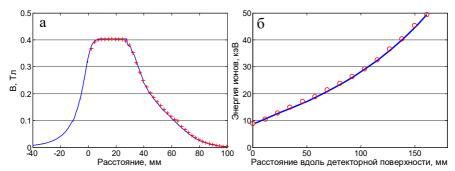
**Рис. 3. а** — магнитное поле вдоль центральной оси анализатора, линия — расчеты, кресты — измерения;  $\mathbf{6}$  — координаты пересечения ионами водорода различной энергии детекторной поверхности, линия — расчеты, кружки — измерения.
