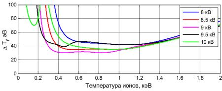
**Figure 17.** Оценка погрешности определения ионной температуры для различных напряжений обдирочной фольги (подробное описание в тексте).
