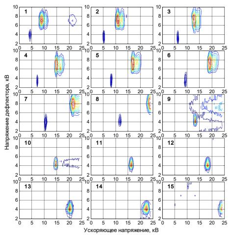
Рис. 15 Калибровочное сканирование по напряжениям источника ионов и дефлекторных пластин с частично поврежденной обдирочной фольгой и  $U_{\rm foil}=0$ . Каждый график соответствует отклику конкретного канала анализатора (указан номером в левом верхнем углу графика). Сигналы от частиц с массой m=1 наблюдаются при отклоняющем напряжении около  $7~{\rm kB}$ , в то время как сигналы от частиц с массой m=2 наблюдаются при отклоняющем напряжении около  $4~{\rm kB}$ .
