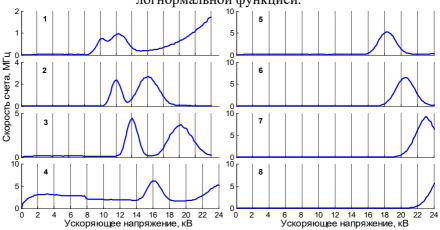
**Рис. 7.** Сигналы каналов 1-8 анализатора в зависимости от ускоряющего напряжения калибровочного источника ионов. Напряжение на обдирочной фольге +8 кВ, напряжение дефлекторных пластин -8 кВ, ионный источник работал на остаточном вакууме  $10^{-5}$  Па.
