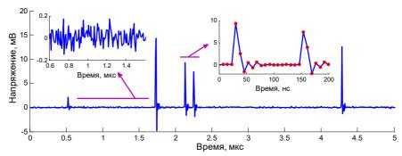
Рис 5. Участок осциллограммы одного из каналов анализатора в выстреле токамака ST40 (сигнал инвертирован для наглядности). Напряжение каналотрона 2 кВ, полный диапазон регистрации АЦП 400 мВ. Уровень шума и форма импульса показаны на врезках.
