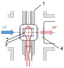
**Рис. 4.** Калибровочный ионный источник. 1 – высоковольтный корпус, 2 – нить накаливаемого катода, 3 – сетка ионного источника, 4 – ускоряющий зазор.
