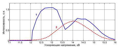
Рис. 8. Отклик канала № 3 анализатора при сканировании ускоряющего напряжения источник ионов. 1 — частично поврежденная фольга (с отверстиями), ионы  $H^+$ , нулевое напряжение на фольге; 2 — неповрежденная фольга, ионы  $H^+$ , напряжение на фольге +8 кВ.
