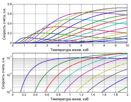
**Рис. 16.** Функции отклика каналов анализатора. Равновесная (максвелловская) водородная плазма, пассивная мишень,  $U_{\text{foil}}$ =+8 kV. Одни и те же функции отклика приведены на верхнем и нижнем рисунке в различных масштабах.
