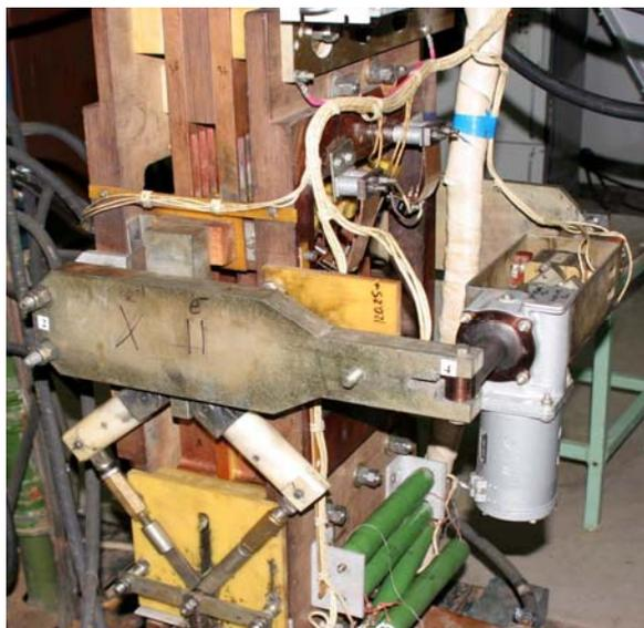
*Рис. 51. Механический коммутатор главного поля Б4.*
