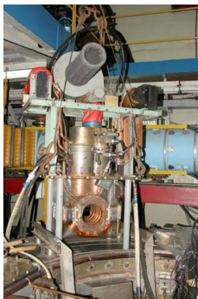
Рис. 53. Общий вид ускоряющей системы и питающего усилителя ВЧ мощности перед постановкой в синхротрон.
