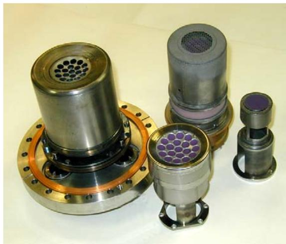
Рис. 27. Пушка ЭЛИТ до (справа) и после (слева) модернизации. Отдельно показаны катодные узлы.
