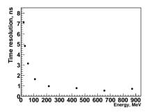
Рис. 3. Зависимость временного разрешения канала электроники калориметра с новыми платами (формирователь + флэш-АЦП) от амплитуды генераторного сигнала.
