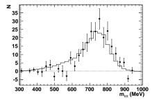
Рис. 12. Спектр двухфотонных инвариантных масс для экспериментальных событий в диапазоне  $2E=1450-1550~{\rm MpB}$ . Кривая показывает результат аппроксимации спектра суммой эффекта и фона.
