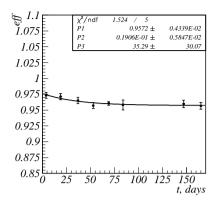
Рис. 7. Зависимость среднего числа фотоэлектронов в счетчике с n=1.05 от времени.
