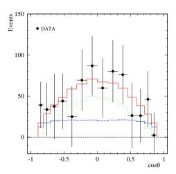
Рис. 11. Распределение экспериментальных событий процесса  $e^+e^- \to n\bar{n}$  по  $\cos\theta$ . Точки с ошибками – экспериментальные данные. Сплошная гистограмма – результат аппроксимации. Точечная гистограмма показывает вклад в распределение, пропорциональный  $G_E$ , а пунктирная – пропорциональный  $G_M$ . верхняя гистограмма – суммарный результат.
