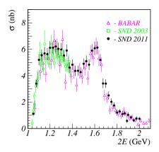
Рис. 16. Сечение процесса  $e^+e^-\to\pi^+\pi^-\pi^0$ , измеренное на ВЭПП-2000, в сравнении с результатами экспериментов СНД на ВЭПП-2М [7] и ВАВАR [8].
