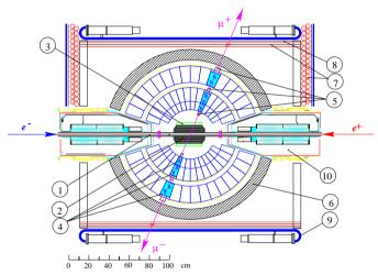
Рис. 1. Детектор СНД — сечение вдоль оси пучков: 1 — вакуумная камера; 2 — трековая система; 3 — аэрогелевые черенковские счетчики; 4 — кристаллы NaI(Tl); 5 — вакуумные фототриоды; 6 — поглотитель; 7 — пропорциональные трубки; 8 — железный фильтр; 9 — сцинтилляционные счетчики; 10 — фокусирующие соленоиды ВЭПП-2000.
