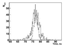
Рис. 4. Временное разрешение счетчика NaI(Tl) при энерговыделении от 50 до 200 МэВ (сплошная линия) и более 200 МэВ (пунктирная линия) для новых плат (формирователь + флэш-АЦП), полученное на пучковых событиях.
