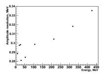
Рис. 2. Зависимость амплитудного разрешения канала электроники калориметра с новыми платами (формирователь + флэш-АЦП) от амплитуды генераторного сигнала.
