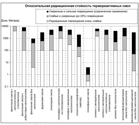
Рис. ПЗ.2. Относительная радиационная стойкость термореактивных смол [1].
