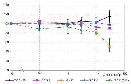
Рис. 2. Относительное изменение модуля упругости в зависимости от дозы.
