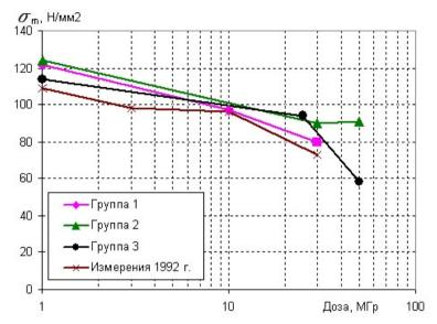
Рис. 4. Зависимость предела прочности компаунда ЭПК-1 от дозы.
