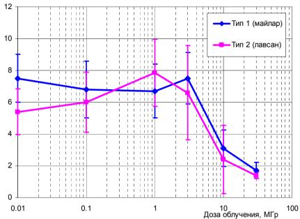
Рис. 7. Напряжение пробоя майлара и лавсана в зависимости от поглощенной дозы (среднее по 12 образцам).
