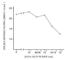
Рис. П1.1. Предел прочности облученных образцов Stabolit 70.
