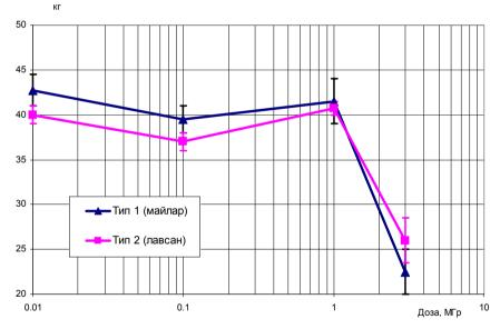
Рис. 8. Прочность майлара и лавсана на разрыв в зависимости от поглощенной дозы.
