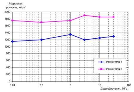
Рис. 9. Прочность полиимидной пленки на разрыв в зависимости от поглощенной дозы.
