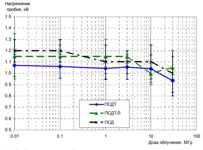
Рис. 10. Напряжение пробоя изоляции в зависимости от дозы облучения
