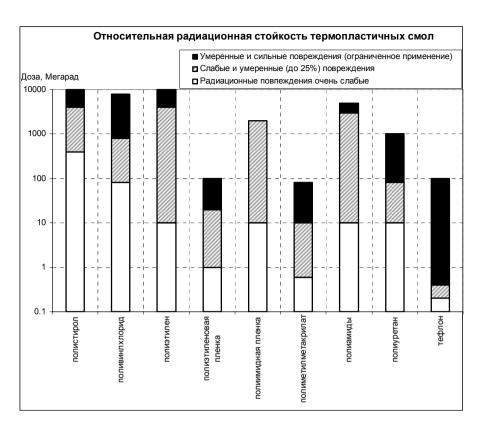
Рис. ПЗ.1. Относительная радиационная стойкость термопластичных смол [1].
