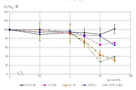
Рис. 3. Относительное изменение предела прочности в зависимости от дозы.
