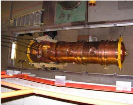
Рис. 22. Установка ускоряющей структуры на ступень (вид сверху).
