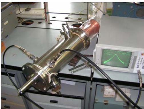
Рис. 17. ВЧ пушка на измерительном стенде.
