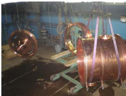
Рис. 8. Элементы ускоряющей структуры перед сборкой.
