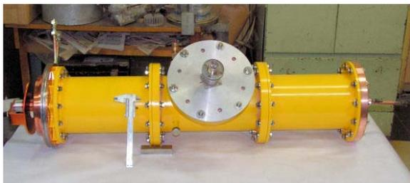
Рис. 19. Общий вид ввода мощности.
