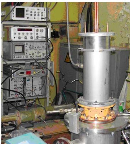
Рис. 20. Стенд для испытания ввода мощности.
