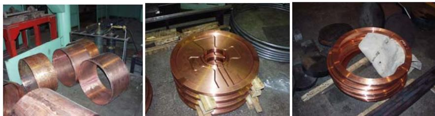
Рис. 9. Заготовки элементов ускоряющей структуры: а) обечайек; б) торцевых стенок; в) соединительных фланцев обечайек.
