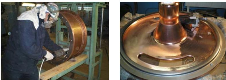
Рис. 11. Процесс очистки поверхностей элементов ускоряющей структуры.
