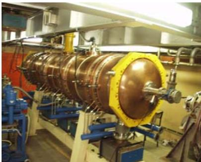
Рис. 3. Ускоряющая структура.
