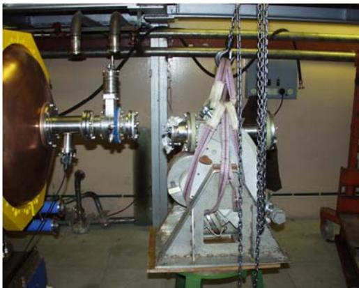
Рис. 27. Установка спектрометра на выход ускорителя.
