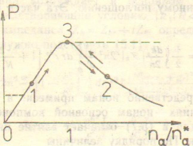
Качественная зависимость поглощаемой в плазме мощности  $P$  от концентрации ионов примеси.
