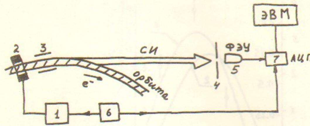
Рис.3. Схема эксперимента. 1 - генератор шума, 2 - магнит, 3 - пластины, 4 - диафрагма, 5 - ФЭУ, 6 - генератор импульсов, 7 - многоканальное АЦП.
