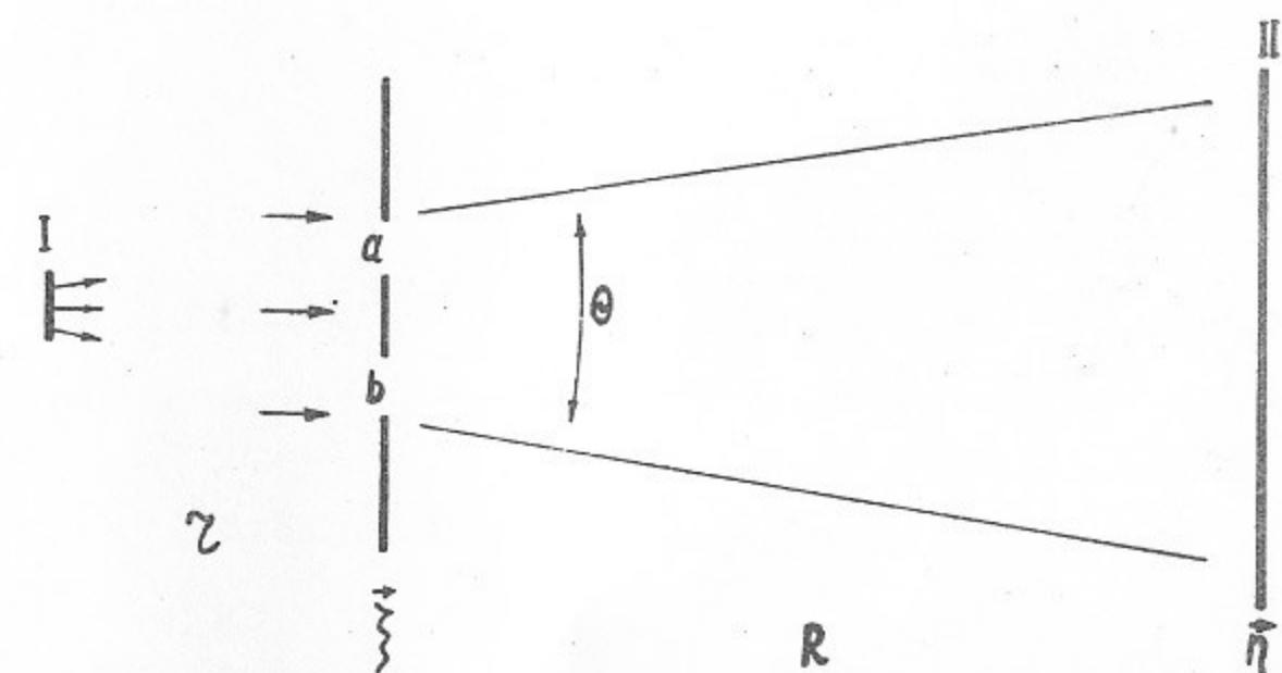
Рис. I. Схема безлинзовой Фурье-голографии. I - источник излучения, II - плоскость регистрации.
