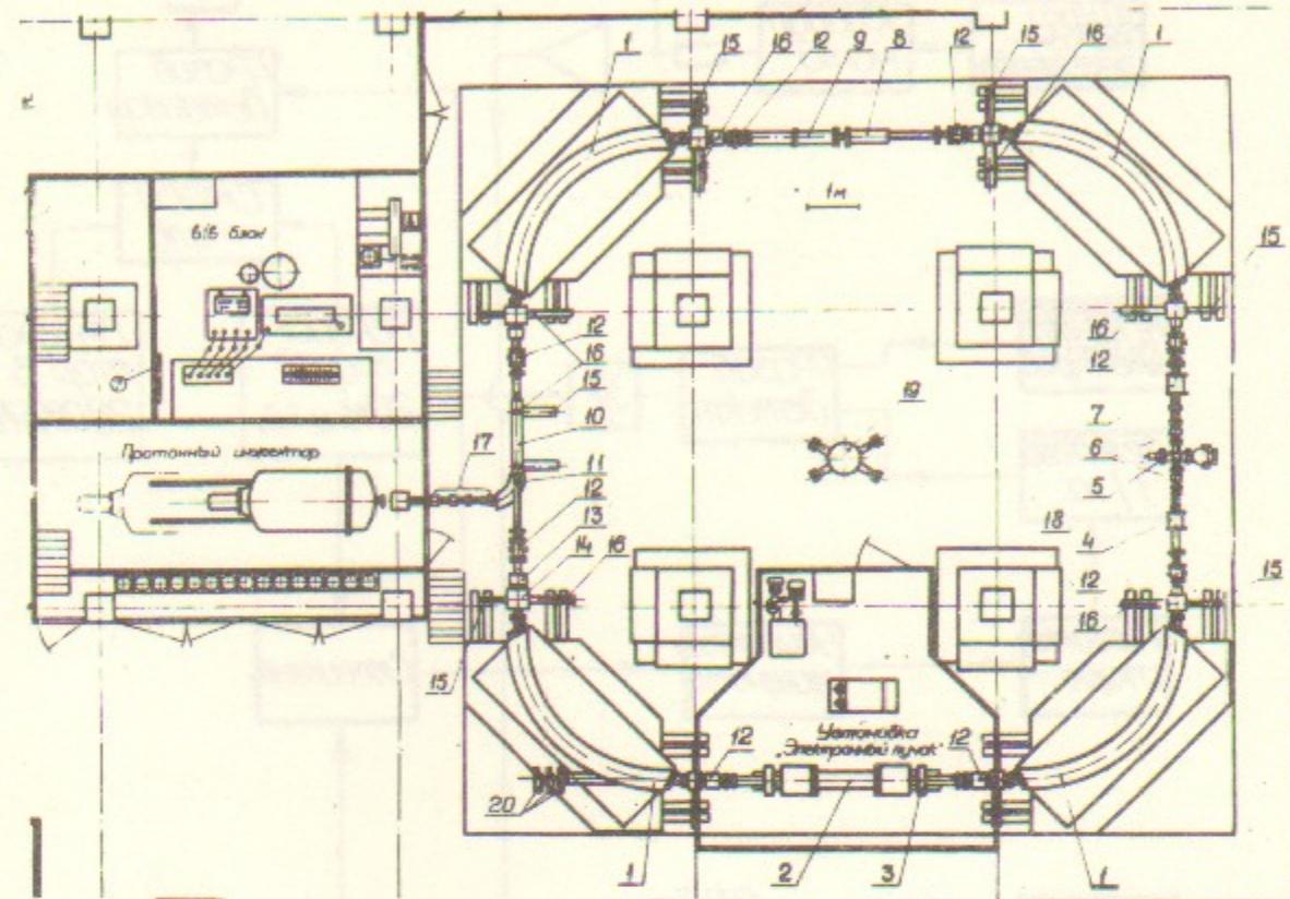
Рис. I. Схема накопителя протонов НАУ-4.
