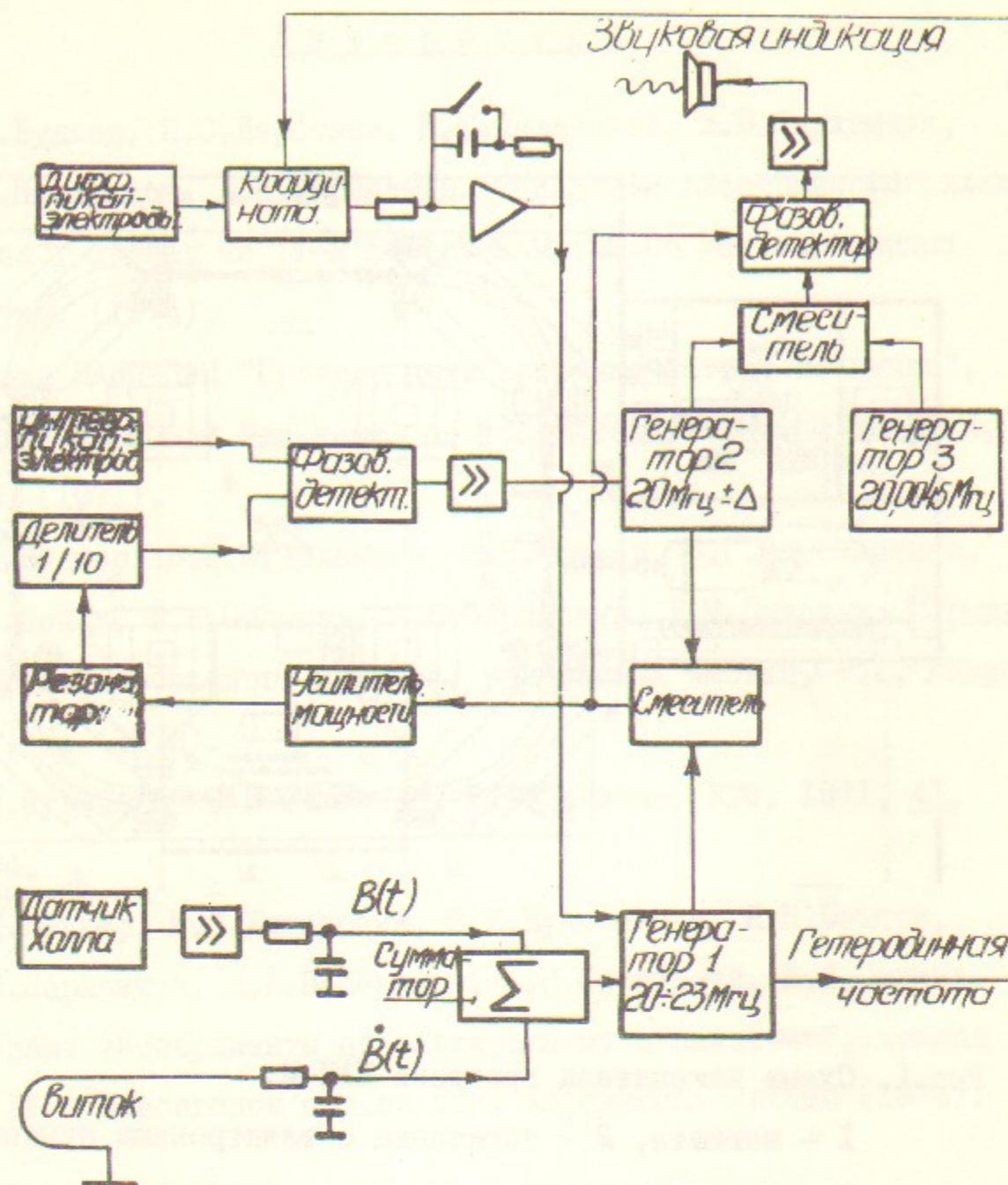
Рис.2. Блок-схема ВЧ-системы.
