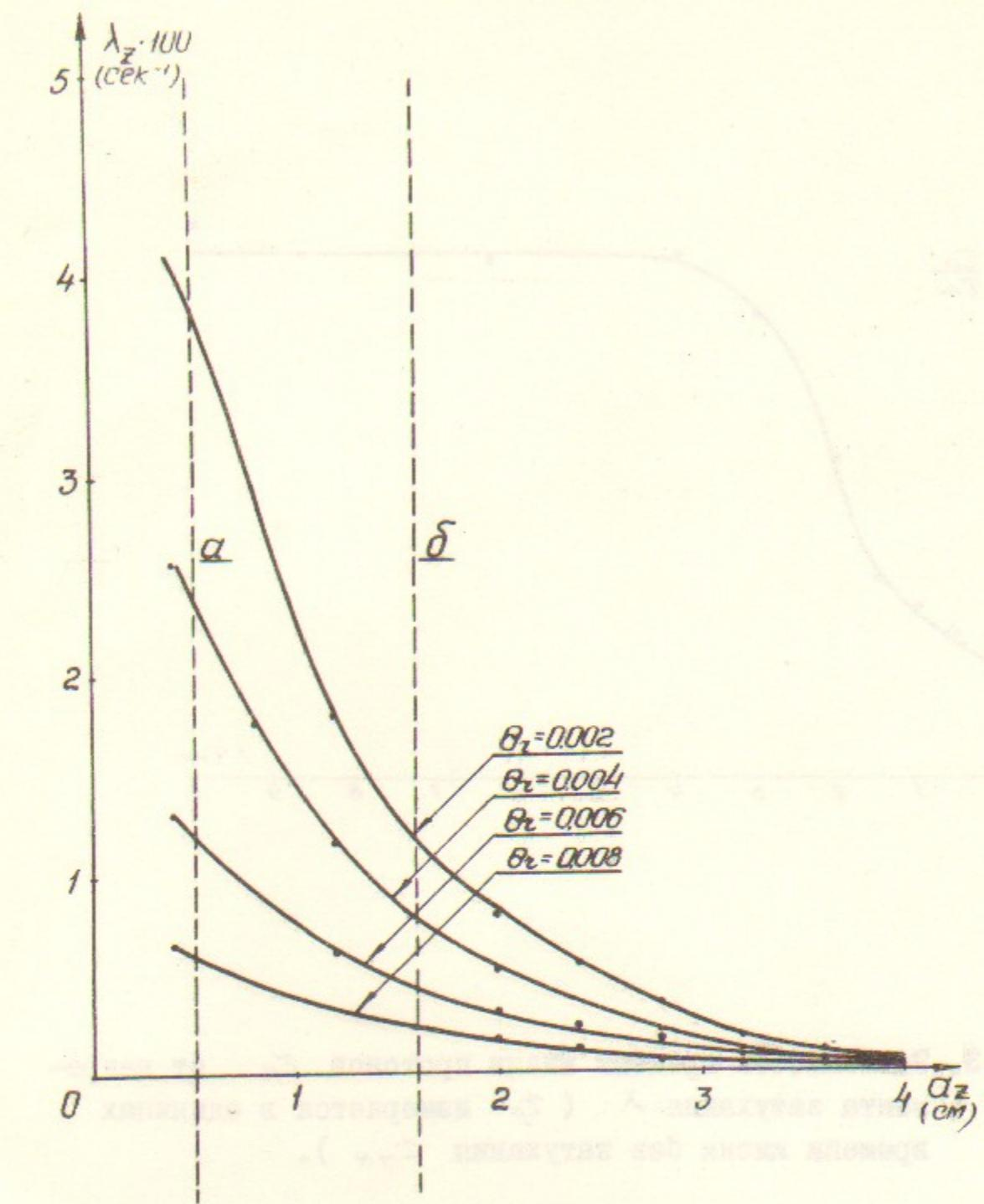
Рис.2. Зависимость декремента аксиальных колебаний от амплитуды аксиальных колебаний и радиального угла ошибки  $\theta_r$ . Кинетическая энергия протонов 150 МэВ, угловой разброс электронов  $\theta_e = 3 \cdot 10^{-3}$ ,  $r_p^e = 0,5$  см,  $r_z^e = 0,5$  см, вертикальный угол ошибки  $\theta_z = 0$ .
