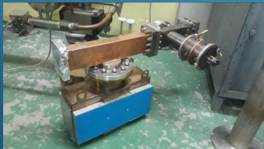
В 2018 году был изготовлен прототип ускоряющей структуры миллиметрового диапазона длин волн для экспериментов с ультракороткими пучками.
