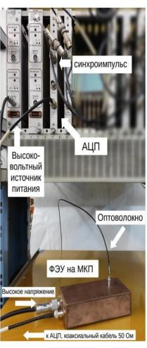
Кварцевое многомодовое оптоволокно марки «Thorlabs» (FG550UEC) длиной 50 м АЦП с полосой пропускания не менее 200 МГц и частотой дискретизации не менее 500 Мвыб/с
