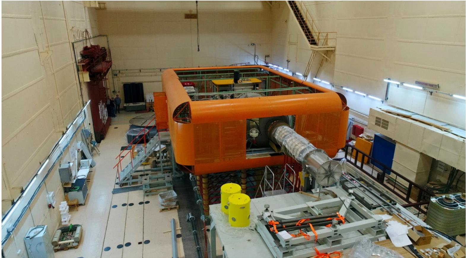
**Вид высоковольтной платформы и ускорительной трубки**
