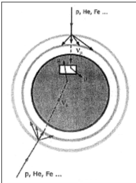
Рис.2 Схема регистрации атмосферных нейтрино в эксперименте SuperKamiokand.
