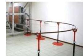
Широкая полоса пропускания от 12 до 140 ГГц с несколькими поворотами и вакуумными окнами
