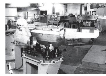
Рис. 9. Участок вакуумной камеры поворотного магнита вместе с его нижней частью и кронштейном для установки линз. Видны отверстия для приемников излучения и вывода синхротронного излучения
