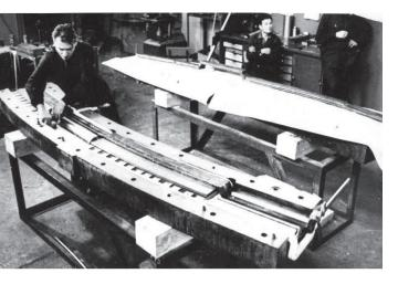
**Рис. 3.** Половина магнита (элемента периодичности) ВЭПП-3 в процессе сборки
