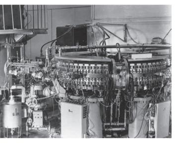
**Рис 6.** Синхротрон Б-3M, слева ИЛУ и канал ИЛУ – Б-3M
