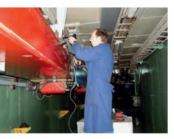
ством ядер и известной с хорошей точностью. По окончании импульса регистрируется сигнал «спада свободной индукции» и находится его частота, которая и является искомой частотой ЯМР. Точность магнитометра составляет порядка 10-6 и лучше для однородных полей.
