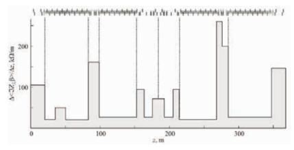
Рис. 24. Измеренное распределение вертикального импеданса вдоль орбиты
