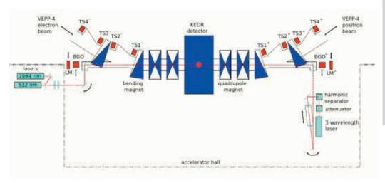
**Рис. 32.** Новая схема экспериментального промежутка с системой регистрации рассеянных электронов (позитронов) детектора КЕДР и с мониторами светимости. ТS – координатные счетчики для регистрации рассеянных электронов (позитронов), LM – мониторы светимости, BGO – детекторы для регистрации комптоновских гамма-квантов
