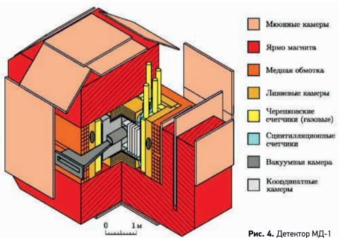
По пути из места встречи частицы пересекали последовательно 9 слоев координатных камер, сцинтилляционные счетчики, черенковские счетчики, 10 слоев ливнево-пробежных камер. Далее, уже за обмоткой магнита и внутри и за ярмом располагалось 3 слоя мюонных камер. В 3,5 метра от места встречи, рядом с орбитой пучка, располагалась
