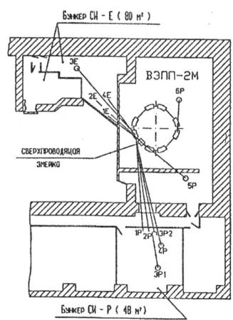
Рис. 19. Расположение экспериментальных помещений и каналов СИ на накопителе ВЭПП-2М (1995 г.). Название станций: 3E — фотоэлектронная спектроскопия для химического анализа; 2P — люминесценция с временным разрешением; 3P1 — метрология в мягком рентгеновском излучении; 3P2 — ВУФ спектроскопия и метрология; 4P, 6P — стимулированная газовая фотодесорбция; 5P — измерение параметров позитронного пучка
