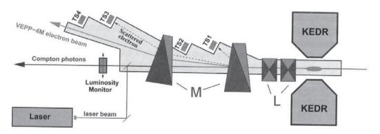
**Рис. 3.** Схема электронной части спектрометра: L – фокусирующие линзы, M – магниты спектрометра, TS1-TS4 – координатные счетчики для регистрации рассеянных электронов
