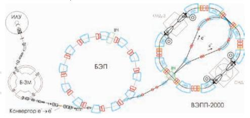
Рис. 5. Схема ускорительного комплекса ВЭПП-2000 со старым инжектором
