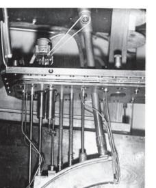
Рис.12. Резонатор ВЭП-1 в сборке на фланце
