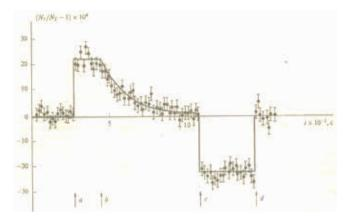
Рис. 47. Результат наблюдения спиновой зависимости СИ на ВЭПП-4 (Е=4.9 ГэВ). К моменту а оба сгустка поляризованы. Интервал а-b – включена деполяризация 2-го сгустка, b-с – деполяризатор выключен и идет поляризация 2-го сгустка, с-d – включена деполяризация 1-го сгустка, d – включена деполяризация 2-го сгустка
