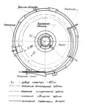
**Рис. 5.** Разрез синхротрона Б-2С в медианной плоскости
