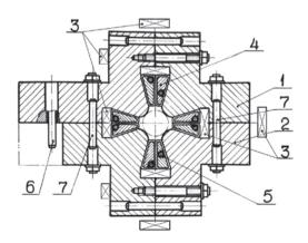
Рис. 6. Квадрупольная линза (разрез).
