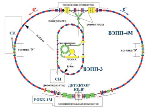
Рис. 7. Схема комплекса ВЭПП-4М
