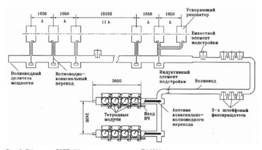
Рис. 9. ВЧ-система ВЭПП-4М, построенная на лампах ГУ-101А
