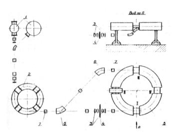
**Рис. 7.** Схема комплекса ВЭПП-2 (до модернизации).
