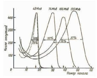
Рис. 10. Спектры монохроматических фотонов на ВЭП-1. Цифры на кривых указывают энергию γ-квантов
