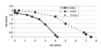
Рис. 22. Влияние змейки на динамическую апертуру (E=1,8 ГэВ, Hzmej =1,8 Тл). Коррекция октуполями (correct, показаны 2 точки) позволяет увеличить величину апертуры до исходной (без змейки)
