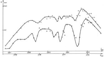
Рис. 18. Время жизни пучка на верхней дорожке в зависимости от частоты бетатронных колебаний без встречного пучка (верхняя кривая) и при наличии встречного пучка (нижняя кривая). E=43 МэВ
