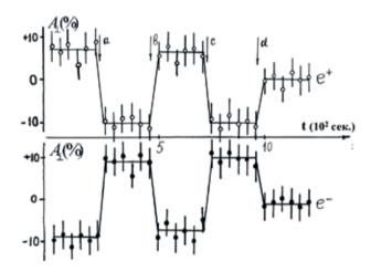
Рис. 13. Асимметрия «вверх-вниз», измеренная поляриметром на основе спирального ондулятора
