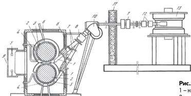
**Рис. 2.** Схема комплекса ВЭП-1.
