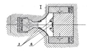
ячейку  $\sim \pi/3$ . Для получения максимального среднего поля, с целью удешевления и упрощения конструкции, магнитная ячейка выполнена единым блоком с короткими фокусирующим дефокусирующим магнитами и двумя длинными магнитами с нулевым градиентом (рис. 2). В фокусирующем и дефокусируюшем участках поля существенно различны и равны 0.46 и 0.78 от среднего. Это было необходимо для обеспечения радиационного затухания радиальных бетатронных колебаний.
