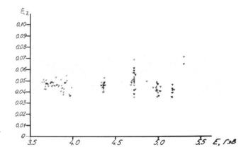
**Рис. 39.** Зависимость параметра пространственного заряда  $\xi_z$  от энергии
