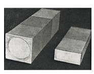
**Рис. 2.** Кристаллы для калориметра детектора СНД
