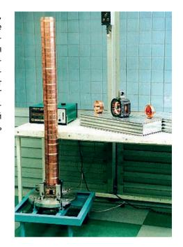
**Рис. 8.** Ускоряющая структура на измерительном стенде перед пайкой
