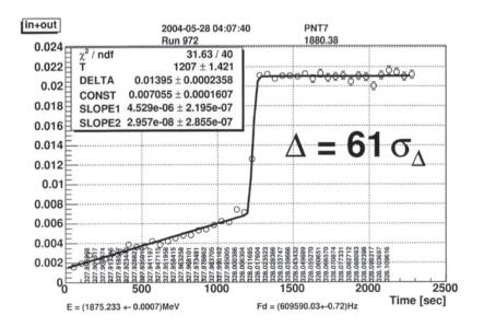
**Рис. 29.** Сканирование частотой деполяризатора. Показан деполяризационный скачок в скорости счета тушековских электронов
