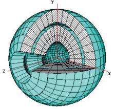
**Рис. 2.** Конфигурация кристаллов калориметра СНД
