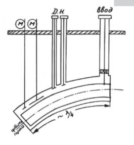
Рис.11. Схема резонатора ВЭП-1. ДН – датчики напряжения, М – механизмы подстройки, грубой и тонкой
