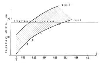
Рис. 20. Область бетатронной автофазировки (заштриховано), обязанная резонансу  $3Q_r=2$  в зависимости от частоты радиальных бетатронных колебаний (расчет). Нижняя граница области соответствует максимальной допустимой амплитуде, т.е. определяет динамическую (магнитную) апертуру. Можно видеть хорошее совпадение измеренного значения динамической апертуры с расчетом
