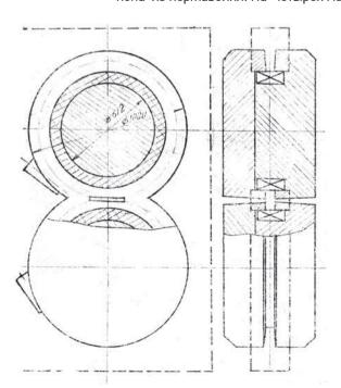
установлены съёмные фланцы с двойным уплотнением, наружным на вакуумной резине, внутренним на свинцовых прокладках. В этой конструкции создавался промежуточный объем между высоким вакуумом и атмосферой.
