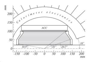
Рис. 1. Расположение дрейфовой камеры внутри СНД (показана в виде частых горизонтальных полосок). Снаружи камеры расположен аэрогелевый черенковский счетчик АСС
