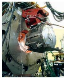
**Рис. 28.** Слева: обработка сложного полюсного профиля четвертинки магнитопровода линзы БЭП на станке с ЧПУ, 08.10.2014. Справа: соленоид, подвешенный на КМД-3 для вкатывания на кольцо ВЭПП, 14.11.2014
