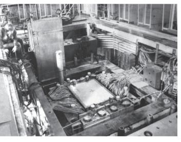
Рис. 7. Момент сборки детектора: опускается один из блоков ливневопробежных камер под наблюдением автора статьи (слева)
