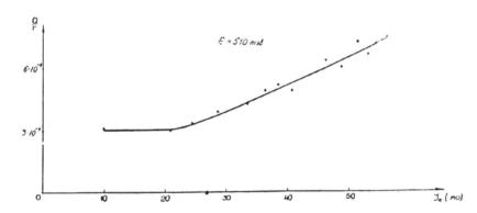
Рис. 16. Отношение кулон-амперов (Q) к числу событий (Г) тормозного излучения от тока. График отражает увеличение размера пучков при увеличении тока
