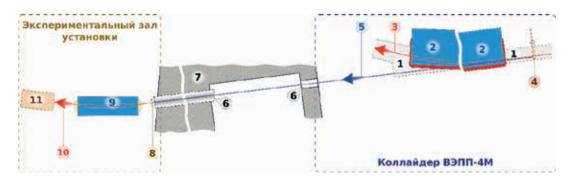
Рис. 38. Схема получения тестового пучка электронов: 1 – вакуумная камера, 2 – дипольные магниты коллайдера ВЭПП–4М, 3 – первичные электроны, 4 – подвижной конвертор, 5 – тормозные гамма-кванты, 6 – каналы, 7 – бетонная стена (радиационная защита), 8 – конверсионная мишень, 9 – поворотный магнит. 10 – тестовые электроны. 11 – прототип детектора
