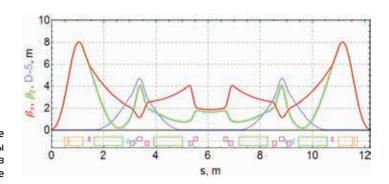
**Рис. 6.** Структурные функции половины кольца ВЭПП-2000 в номинальном режиме
