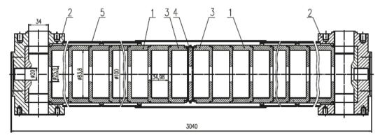
**Рис. 7.** Ускоряющая секция. 1 – регулярная ускоряющая ячейка, 2 – трансформатор типа волны, 3 – переходная (соединительная) ускоряющая ячейка, 4 – соединительная диафрагма, 5 – рубашка охлаждения
