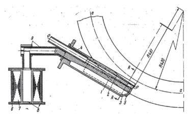
Рис. 9. Компенсирующая система для ввода пучка. 1 — внутренняя шина, 2 — съёмная крышка короба, 3 — короб, он же наружная шина, 4 — экранирующая стальная труба, 5 — стальные накладки, 6 — тороидальный пакет железа трансформатора, 7 — первичная обмотка импульсного трансформатора, 8 — тороидальная медная обечайка, она же вторичная обмотка трансформатора, 9 — коаксиальный токоподвод
