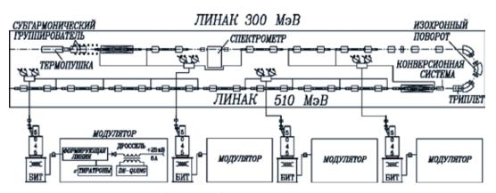
Рис. 6. Общая схема форинжектора
