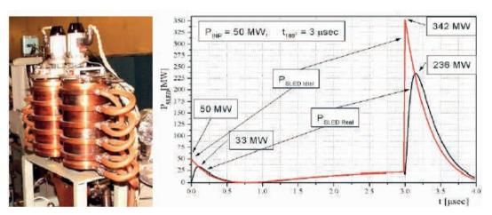
**Рис. 13.** Система умножения мощности SLED, изготовленная в ИЯФ СО РАН (слева). Зависимость ВЧ мощности на выходе SLED от времени для идеального (красная кривая справа) и реального (черная кривая) случаев
