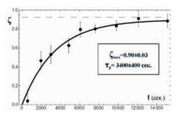
**Рис. 4.** Процесс самополяризации на ВЭПП-2М
