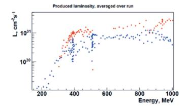
Рис. 31. Светимость ВЭПП-2000, усреднённая по 10% лучших заходов, по данным КМД-3. (синие точки получены со старым инжектором; красные – после модернизации)
