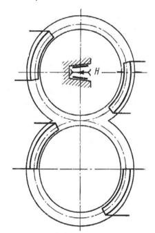
**Рис. 14.** Расположение пластин для коррекции частот бетатронных колебаний и их резонансной раскачки, управления вертикальным положением орбиты и отсоса ионов
