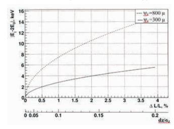
**Рис. 30.** Сдвиг средневзвешенной энергии в системе центра масс и потеря светимости при неточном сведении пучков по вертикали  $(dz/\sigma_z)$  для разных значений вертикальной пси-функции, имеющей разные знаки для электронов и позитронов
