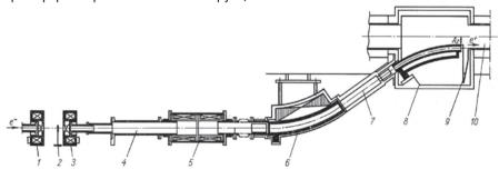
Рис. 12. Схема размещения элементов позитронного тракта ВЭПП-2: 1 – первая Ха-линза, 2 – конвертор, 3 – вторая Ха-линза, 4 – вакуумпровод, 5 – квадрупольный дублет, 6 – нижний впускной магнит, 7 – равновесная траектория впуска, 8 – верхний (впускной) септум-магнит, 9 – медианная плоскость накопителя, 10 – высоковакуумная камера накопителя
