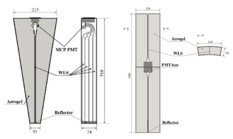
**Рис. 4.** Слева: торцевой счетчик АШИФ. Справа: два баррельных счетчика АШИФ в одном корпусе
