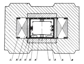
**Рис. 9.** Поперечный разрез квадранта ВЭПП-2 (после реконструкции).
