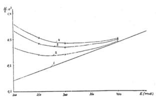
**Рис. 17.** Зависимость разброса энергий в пучке от энергии для разных токов. 1-I=0 мА, 2-I=2 мА ,3-I=4 мА, 4-I=7 мА [15]
