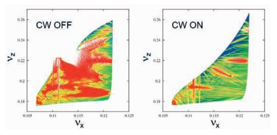
**Рис. 1.** Разброс бетатронных частот в пучке, вызванный нелинейным взаимодействием со встречным сгустком. Динамические характеристики различных траекторий показаны цветами: красный соответствует стохастическому движению, синий – регулярному. Видно, как в области перекрытия сильных резонансов возникают стохастические области, и как они уменьшаются при включении крабовых секступолей
