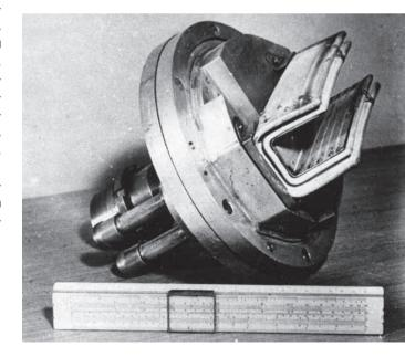
**Рис. 6.** Резонатор синхротрона вместе с фланцем
