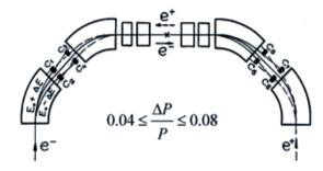
**Рис. 6.** Расположение счетчиков  $(C_1 - C_8)$  нового поляриметра ВЭПП-2М
