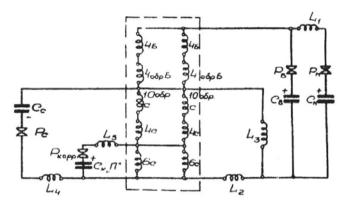
Рис. 7. Схема питания синхротрона
