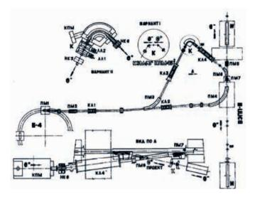
Рис. 8. Схема электрон-позитронного канала накопителя ВЭПП-3. Буквами обозначены: ПМ – поворотные магниты; КЛ – квадрупольные линзы; НК – нацеливающие катушки; пр – пробники; И – инфлекторы; К – блок конверсии; КЭМ – сильнополевой магнит для фокусировки электронов (вариант 1); КПМ – магнит для фокусировки позитронов (вариант I) и согласования дисперсионных функций (вариант II);
