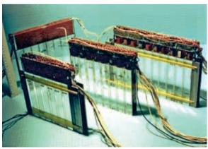
**Рис. 6.** Отдельные кристаллы германата висмута и их сборки в блоки торцевого калориметра детектора КМД-2
