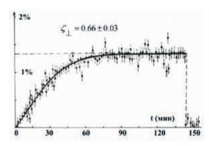
**Рис. 17.** Радиационная поляризация на ВЭПП-4
