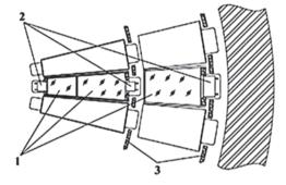
Рис. 3. Расположение кристаллов и фототриодов калориметра СНД: 1 – кристаллы NaI(TI); 2 – фототриоды; 3 – несущие сферы
