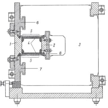
**Рис. 4.** Поперечный разрез магнита Б-3M.
