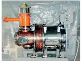
**Рис. 14.** Слева: слой керамических элементов коаксиальной нагрузки для поглощения высших мод. Справа: резонатор на измерительном стенде
