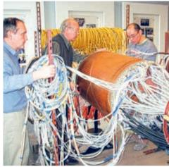
**Рис. 3.** Слева: дрейфовая камера детектора КМД-2. Хорошо видна «струйная» структура ячеек камеры. Справа: Z-камера детекторов КМД-2 и КМД-3 и создавшие её физики С.И. Редин, Г.В. Федотович, А.Л. Сибиданов
