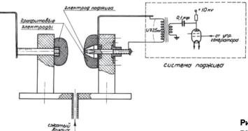
**Рис. 8.** Разрядник вместе с системой поджига
