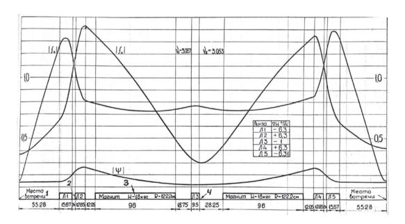
Рис. 4. Структура элемента периодичности (четверти коллайдера)
