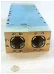
**Рис. 3.** Слева – промежуток встречи с-т фабрики с детектором, справа – ярмо двухапертурной сверхпроводящей линзы финального фокуса
