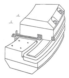
**Рис. 5.** Поворотный магнит (одна четверть удалена)
