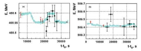
**Рис. 25.** Измерения энергии методами ОКР (чёрные точки), резонансной деполяризацией (красные) и контроль по ЯМР (голубые) в спецрежиме «тёплой оптики» с выключенными соленоидами
