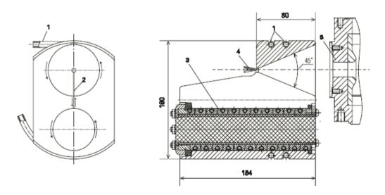
**Рис. 10.** Схема источника позитронов ИК ВЭПП-5. Стрелками на схеме слева обозначены поверхностные токи. 1 – трубки водяного охлаждения; 2 – паз между конической полостью и полостью первичной обмотки (ширина паза – 0,2 мм; на рисунке ширина паза изображена в неправильном масштабе, т. к. иначе оба края разреза сливаются); 3 – импульсная катушка (первичная обмотка); 4 – конверсионная мишень, 5 – начало ускоряющей структуры
