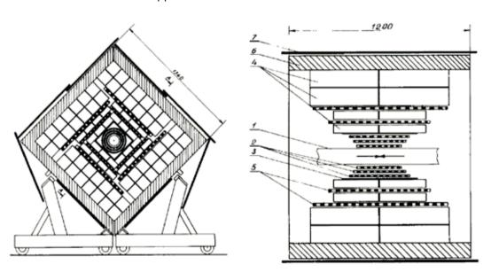
**Рис. 1.** Схема нейтрального детектора: 1 – вакуумная камера ВЭПП-2М; 2 – цилиндрические пропорциональные камеры; 3 – пластиковые сцинтилляционные счетчики; 4 – сцинтилляционные счетчики на основе кристаллов Nal; 5 – ливневые пропорциональные камеры; 6 – железный поглотитель; 7 – пластиковые сцинтилляционные счетчики антисовпадений
