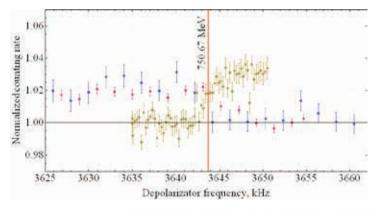
Рис. 23. Слева: первое измерение энергии по резонансной деполяризации, с включёнными соленоидами (2010 год). Три сканирования (с разными скоростью и направлением сканирования) частотой деполяризатора, и скачок ~3% в скорости счёта тушековского поляриметра. Снизу: расчётная степень поляризации для полярности соленоидов (+ - + -) и (+ - - +)
