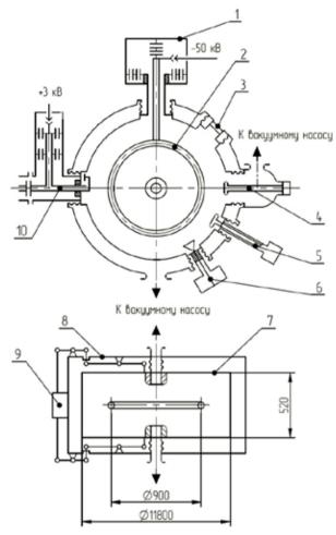
Рис. 22. Ускоряющий резонатор накопителя ВЭПП-4:
