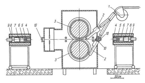
**Рис. 6.** Система счётчиков для двойного тормозного излучения на ВЭП-1: 1-3, 10 — элементы ускорителя, 4-9 — элементы счётчиков с кристаллами Nal(Tl)
