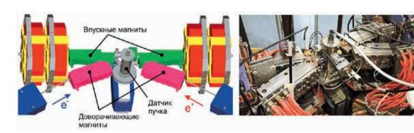
Рис. 12. Участок инжекции в 3D-модели (слева) и в реальности (справа)
