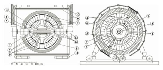
Рис. 1. Детектор СНД на ВЭПП-2М. Слева – сечение вдоль оси пучков: 1 – вакуумная камера ВЭПП-2М; 2 – дрейфовые камеры; 3 – цилиндрический сцинтилляционный счетчик; 4 – световоды; 5 – ФЭУ; 6 – кристаллы Nal; 7 – вакуумные фототриоды; 8 – железный поглотитель; 9 – стримерные трубки; 10 – железные пластины; 11 – сцинтилляционные счетчики; 12 – магнитные линзы; 13 – поворотные магниты. Справа – сечение поперек оси пучков
