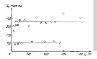
Рис. 18. Зависимость произведения времени быстрого затухания на ток пучка в зависимости от тока. Пластины разведения пучков не согласованы (1), нагружены на волновое сопротивление (2)
