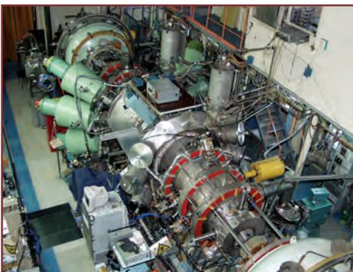
На установке ГДЛ используется комплекс из шести нагревных и двух диагностических инжекторов пучков быстрых атомов водорода
