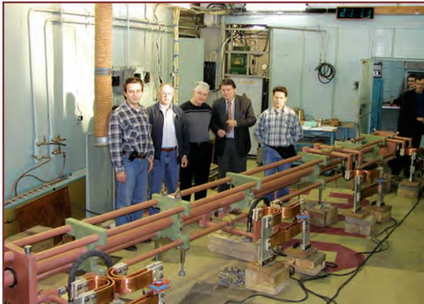
Испытания токораспределительного шинпровода в ЭП-1:
