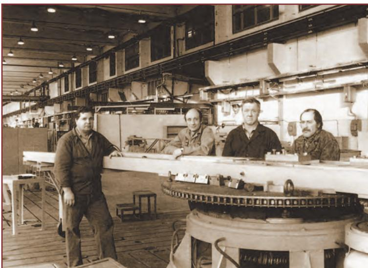
Разворачиваются работы по производству 6-метровых дипольных магнитов для установки LHC (ЦЕРН).
