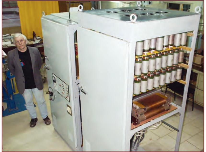
Импульсный источник питания для конверсионного магнита NLC Стенфордского линейного коллайдера (США). Энергия в одном пульсе 1 кДж, частота повторения 120 Гц (1999 г.)
