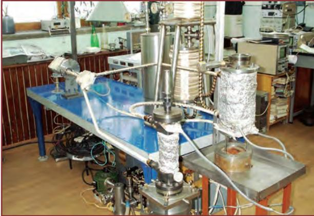
Прототип двухконтурной системы прокачки жидкого металла на основе сплава свинца с оловом
