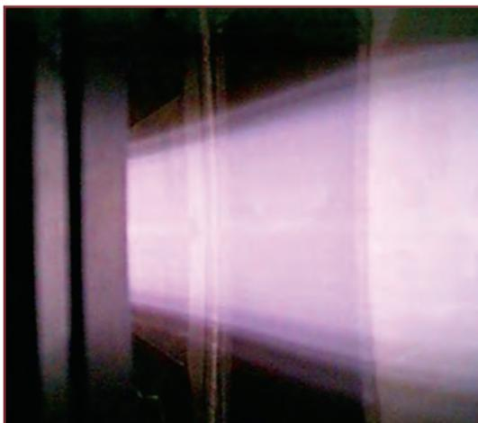
Фотография плазмы в многопробочном магнитном поле
