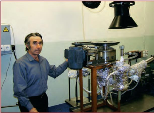
В. С. Попов. Шестеренчатый жидкометаллический насос обеспечивает прокачку сплава свинца (90 %) и олова (10 %) при температуре 290 °С через 2 мм трубку длиной 32 мм со скоростью 15 м/с. Максимальное давление в контуре 0,5 МПа
