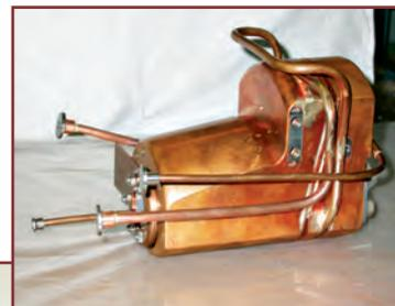
Импульсный конверсионный магнит для сбора позитронов с впервые примененным магнитным полем до 100 кГс, используется на инжекционном комплексе ВЭПП-5 (2000 г.)
