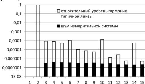
Рис.7. Шум измерительной системы и типовой уровень амплитуды гармоник.
