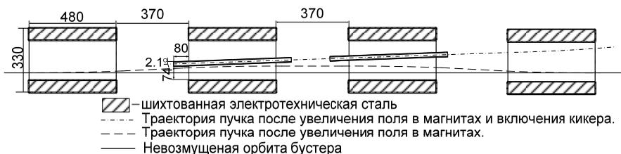
Рис. 10. Байпас с магнитными экранами.
