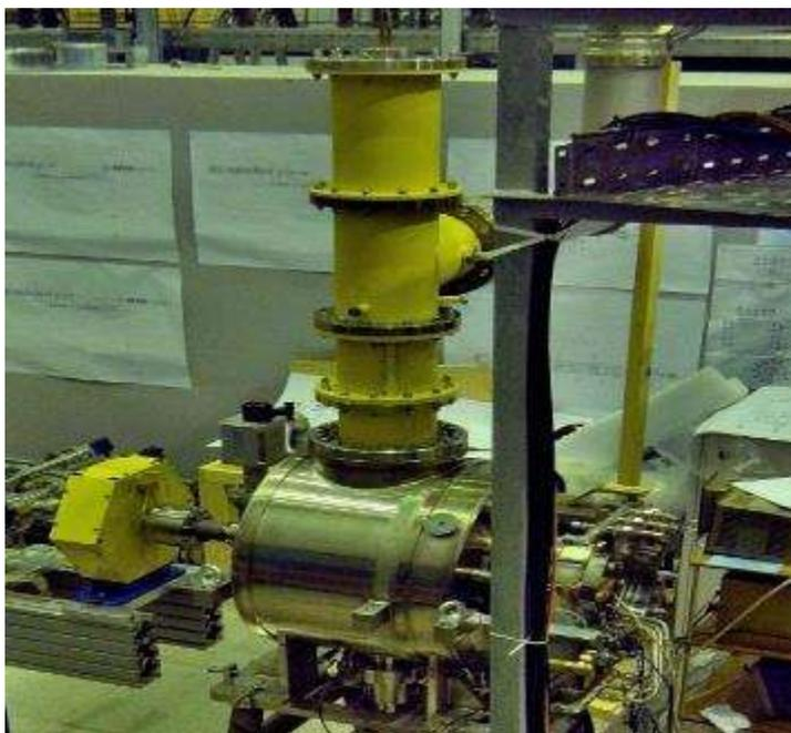
Рисунок 4.2 - Внешний вид ВЧ пушки линейного ускорителя ЦКП «СКИФ»
