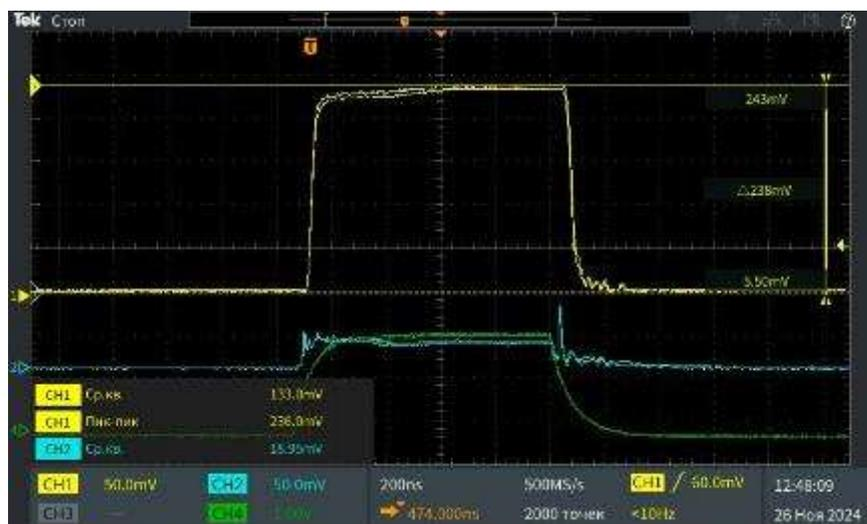
Рисунок 5.33 –Осциллограммы детекторов: 1 (желтый сигнал) – огибающая падающей в согласованную нагрузку СВЧ мощности, 2 (синий сигнал) – огибающая отраженной от входного резонатора СВЧ мощности, 4 (зеленый сигнал) – контрольный сигнал работы возбуждающего усилителя
