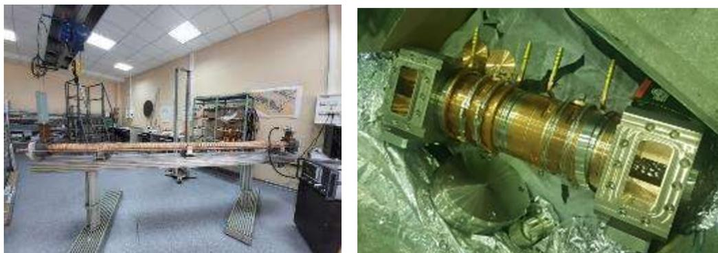
Рисунок 4.16 - Ускоряющие структуры регулярная (слева) и ПГ
