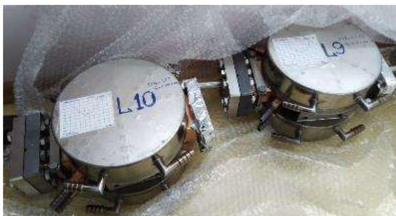
Рисунок 4.23 - Изготовленные волноводные СВЧ нагрузки
