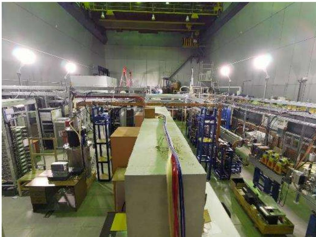
Рисунок 6.2 - ЛИНАК-20 в ИЯФ СО РАН: левая часть помещения предназначена для системы питания и электроники, правая – для линейного ускорителя
