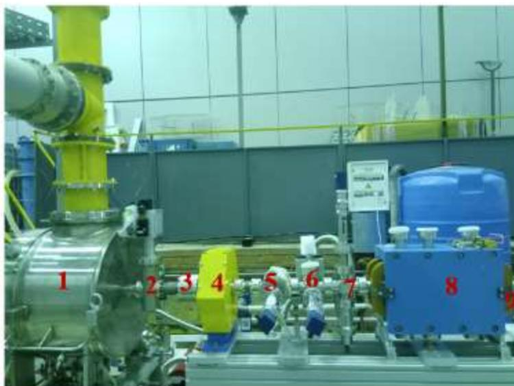
Рисунок 6.7 - Состав оборудования для запуска ВЧ пушки: 1 – пушка, 2 – вакуумный шибер, 3 – датчик тока FCT (Fast Current Transformer), 5 – датчик черенковского излучения, 6 – люминофорный датчик, 7 – коллиматор, 8 – спектрометр, 9 – цилиндр Фарадея
