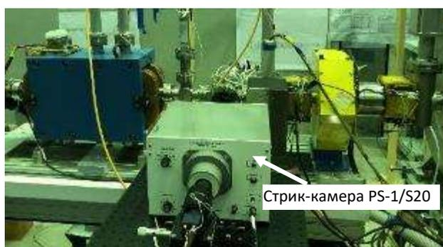
Рисунок 6.14 - Слева – схема черенковского датчика, справа – фотография стрик-камеры, установленной на линейный ускоритель ЦКП «СКИФ»
