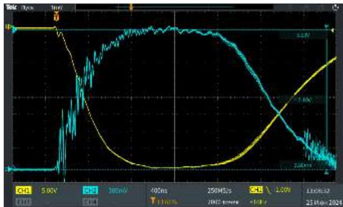
Рисунок 5.31 - Осциллограммы: желтая – напряжение с модулятора клистрона, голубая – ток катода. Микропервеанс равен  $1.7 \text{ мкА/В}^{3/2}$
