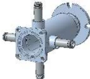
Рисунок 1.20 - Полосковый датчик положения пучка
