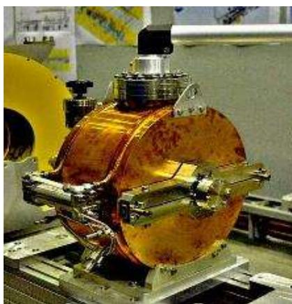
Рисунок 4.7 - Резонатор канала группировки на 535.5 МГц
