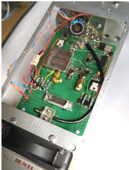
Рисунок 4.6 - Плата управляющего модулятора катодно-сеточного узла
