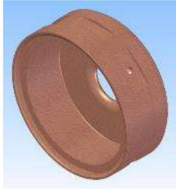
Рисунок 3.1 - Ускоряющая ячейка диафрагмированного волновода
