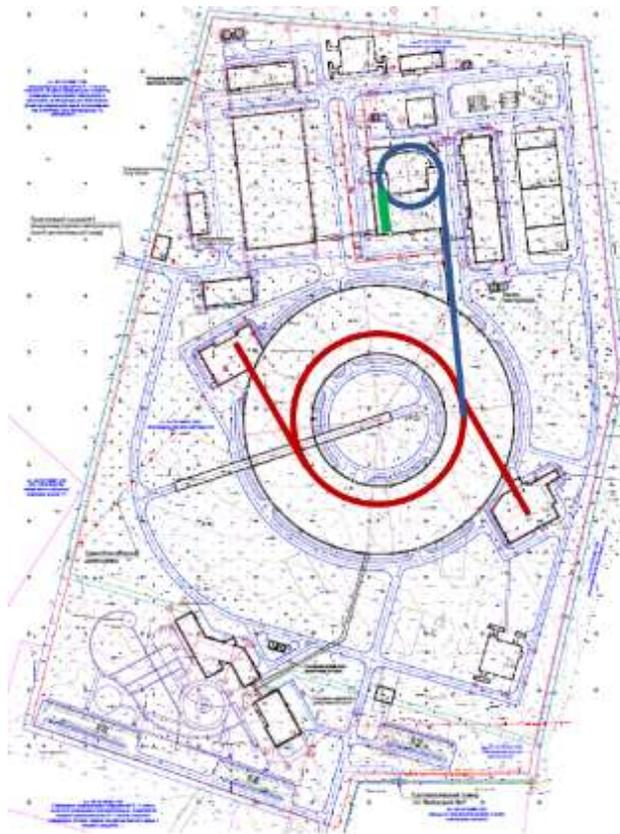
Рисунок 1.2 - Строительный план участка для размещения ЦКП «СКИФ». Красным цветом показан основной накопитель электронов (и, для примера, два длинных канала вывода излучения), синим – синхротрон-бустер, зеленым – линейный ускоритель
