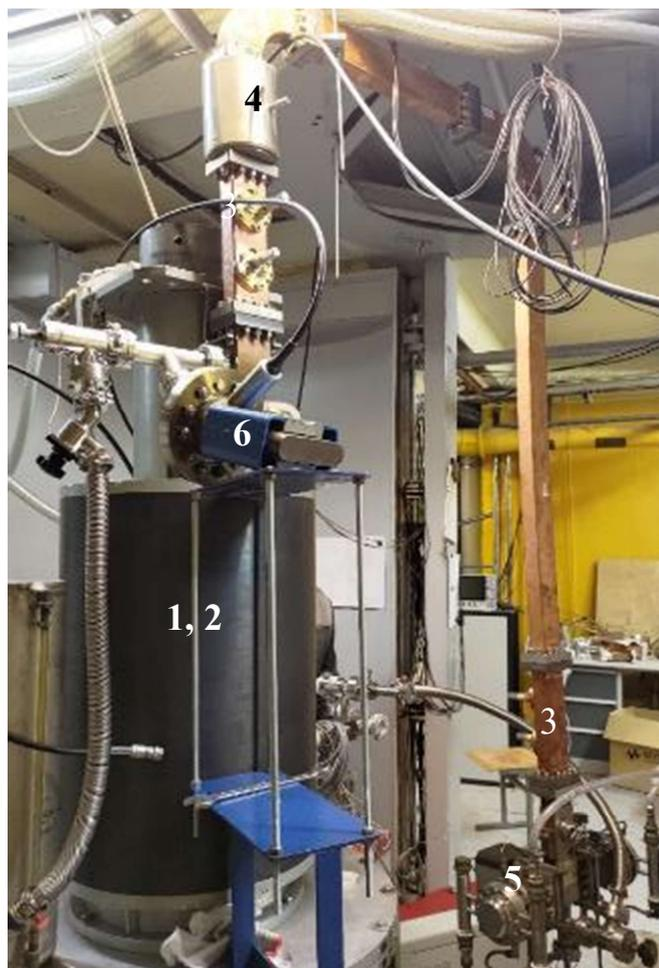
Рисунок 5.23 - Стенд для испытания клистрона: 1 и 2 соленоид и система группировки пучка внутри соленоида соответственно, 3 – измерительные волноводные ответвители, 4 – выходное вакуумное волноводное окно, 5 – согласованная водяная нагрузка, 6 – магниторазрядный насос
