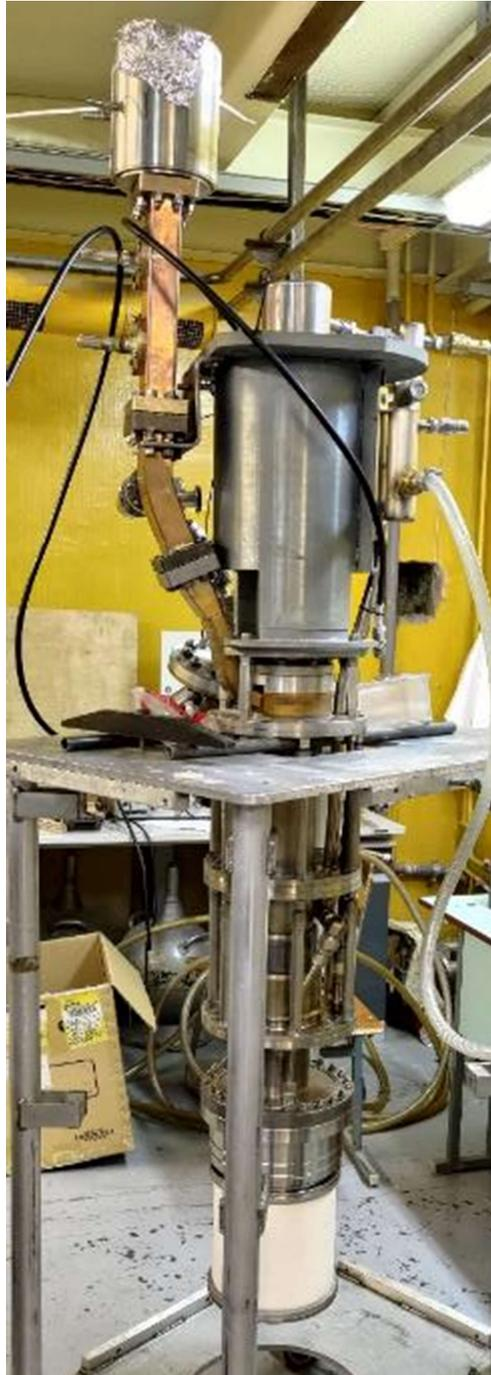
Рисунок 5.17 - Изготовленный клистрон
