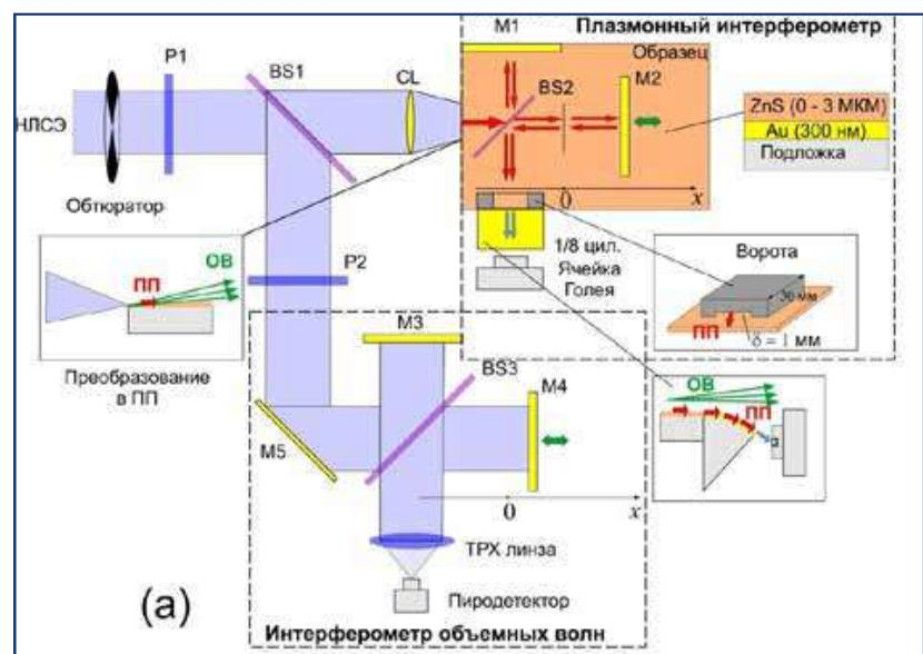
*Оптическая схема полной установки из двух интерферометров, одним из которых является плазмонный. Иллюстрация предоставлена В. Герасимовым.*
