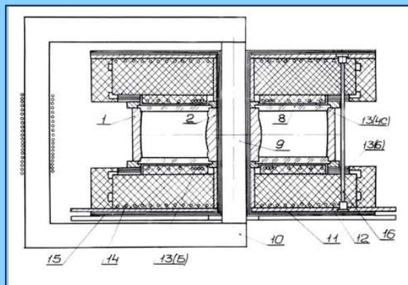
Илл. слева. Общий вид комплекса. Илл. справа. Разрез синхротрона Б-2С в вертикальной плоскости: 1 — наружная обечайка, 2 — внутренняя обечайка, 8 — крышка вакуумной камеры, 9, 10 — бетатронный сердечник, 11 — медные экраны, 13 (Б) — бетатронные витки, 13 (4c) — 4 синхротронных витка, 13 (6) — шестивитковый пакет, 12, 14 — обратные витки, 15 — элемент силовой конструкции, 16 — стягивающие штифты.
