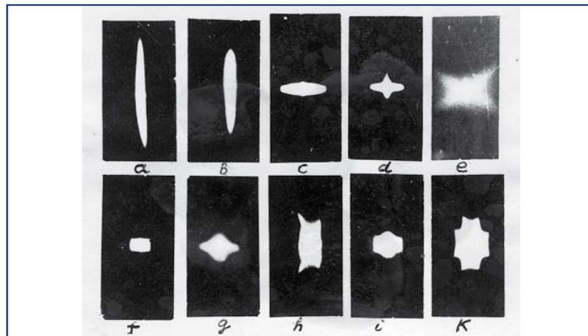
Фотографии поперечного сечения пучка вблизи различных резонансов.
