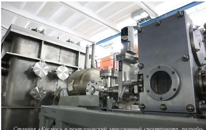
Станция «Космос» и рентгеновский эмиссионный спектрометр, разработанный в ИНХ СО РАН. Фото Т. Морозовой.
